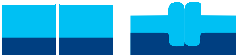
Alinierea și îmbinarea țevelor-sub presiune apar gulere
